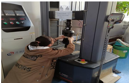
照片3 贾玉娇同学在做拉伸试验
