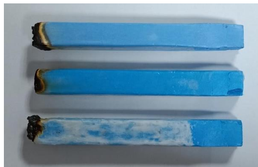
图 17 水配方 UL-94 垂直燃烧测试
