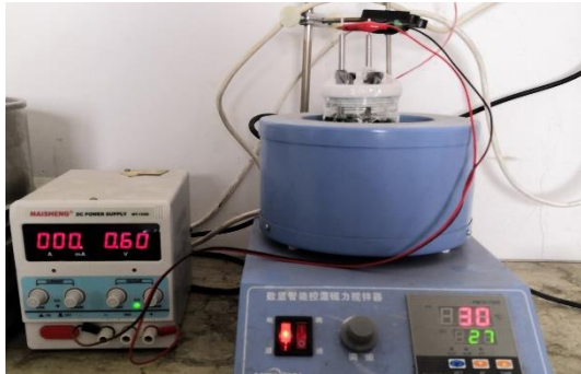
照片2 电镀的数显智能控温磁力搅拌装置
