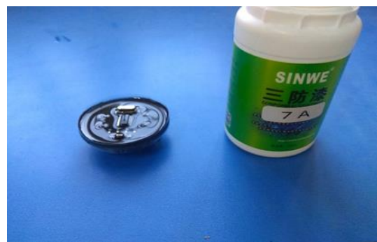
照片9 进行三防处理中的探头主板
